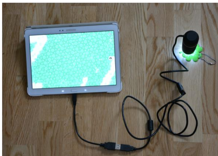
Obr. 5: Připojení USB mikroskopu k tabletu pomocí redukce mikroUSB na USB.
